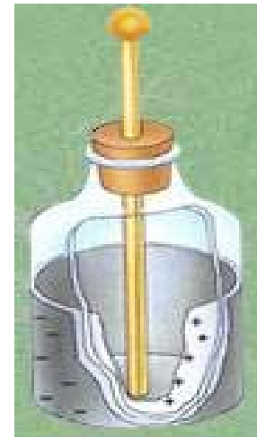
Rys. 1.1 Butelka lejdejska: (a) zasada działania; (b) przykładowe wykonanie.
