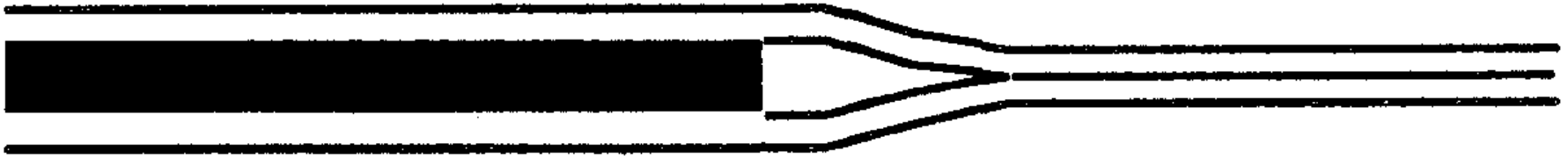
Rys. 5.27. Kawerna na krańcu elektrody sterującej przepustu kondensatorowego
